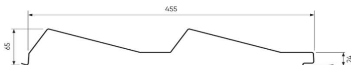
Solape lateral (sistema de fijación oculta) Side lap (hidden fixing system) Recouvrement latéral (système de fixation cachée)
